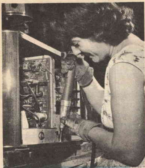
Operazione di fissaggio del telaio nel mobile.
