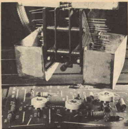
Particolare di uno dei dispositivi per l'inserzione della maggior parte dei componenti.
