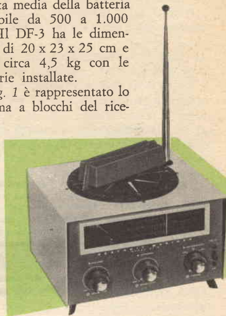
Fig. 1 - Il radiogoniometro DF-3 impiega un'antenna verticale; nell'uso quale indicatore di rotta durante la navigazione utilizza un'antenna a telaio. I rimanenti circuiti dell'apparecchio costituiscono un comune ricevitore radio.
