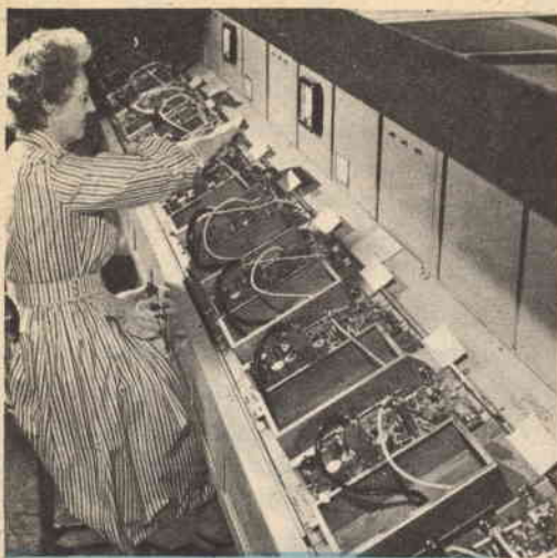
Macchine automatiche per il collaudo e la taratura di circuiti stampati già montati.
