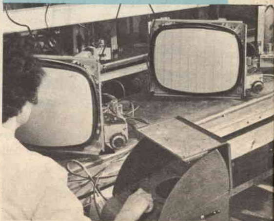
I telai passano attraverso un accurato collaudo prima della sistemazione definitiva nel mobile.
